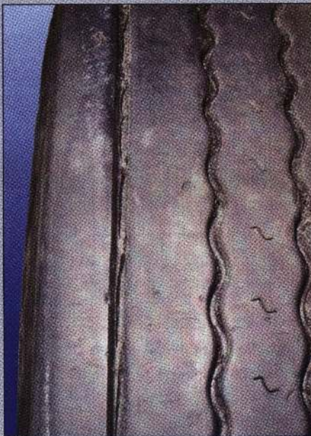
Надрывы (разрывы, трещины) в основании протектора
