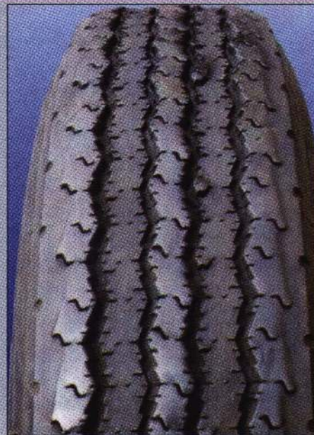
Износ желобом (одной или нескольких дорожек)
