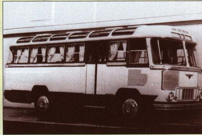
Двухдверный вариант автобуса малой вместимости ПАЗ-652 – опытный образец 1960 года. Фото из архива А. С. Исаева
