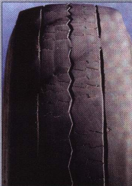
Циклический или волновой износ
