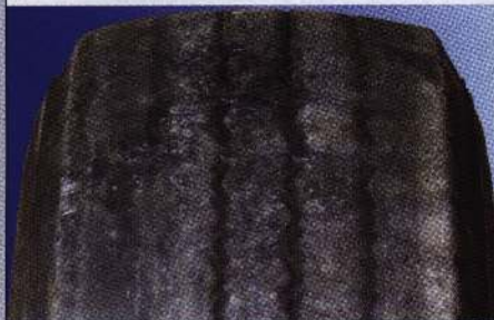
Износ обоих плеч (закругленный)
